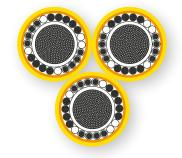
3x(1x50 mm<sup>2</sup> / 20 + 8x1 mm<sup>2</sup>) 3x(1x70 mm<sup>2</sup> / 25 + 8x1 mm<sup>2</sup>)
