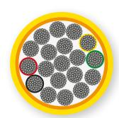
1x35 mm<sup>2</sup> + 4x1 mm<sup>2</sup> 1x50 mm<sup>2</sup> + 4x1mm<sup>2</sup>
