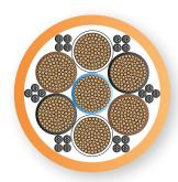
7x25 mm<sup>2</sup> + 6x4x1 mm<sup>2</sup> 7x35 mm<sup>2</sup> + 6x4x1 mm<sup>2</sup>
