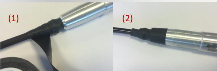
Pour assurer une meilleure étanchéité du système utilisez (à la jonction entre le câble et l'attache) du ruban auto amalgamant (1) ou une gaine thermo rétractable (2). Enfin au niveau de la base du cône, vous pouvez également couler du mastic en silicone.
