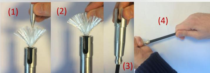
En position verticale, positionnez les fibres autour de l'attache de manière uniforme (1). Placez le cône au centre des fibres (2) puis tirez le câble vers le bas pour faire rentrer le cône dans le câble (3). Une fois connecté, tirez à plusieurs reprises afin d'exercer une première tension sur le câble (4).
