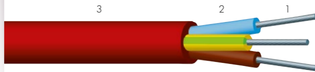
1 • Ame souple en cuivre étamé - classe 5 selon IEC 60228. 2 • Isolant : Caoutchouc de silicone. 3 • Gaine externe : Caoutchouc de silicone.
