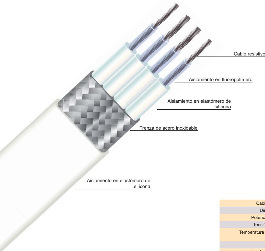
Ejemplo de alambrado eléctrico tipo 1
