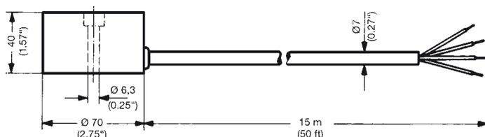
La sonde mixte est installée à l'**intérieur** de la surface chauffée (voir figures 2 et 3, page 16) car elle a pour tâche de contrôler la température du sol au niveau de la surface chauffée quel que soit l'état du chauffage (en marche ou à l'arrêt).
