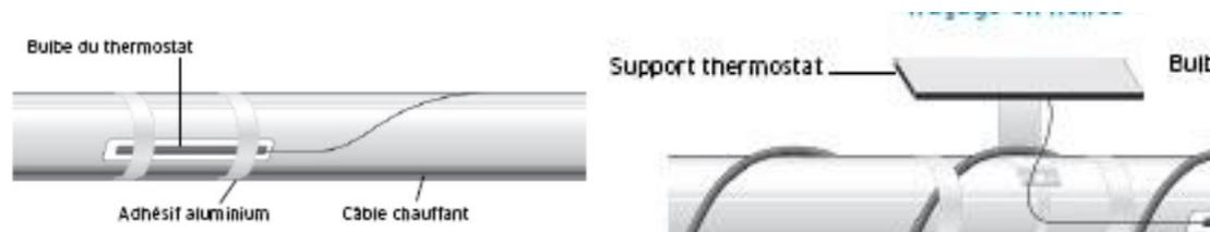
**Figure 1 – Fixation du thermostat**
